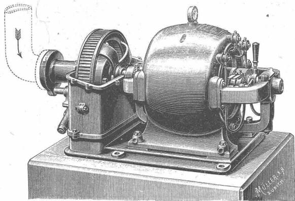
Hochdruckturbine mit direkt gekuppelter Gleichstromdynamo.
