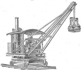
**Dampfwinden u. Dampfkrähne**
