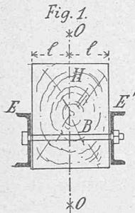
In Fig. 1 seien  $H$  ein Holzkörper,  $E$  und  $E'$  zwei Eisenlaschen von beliebigem Querschnitt (Flacheisen, L-Eisen, □-Eisen u. dgl.), die durch den Bolzen  $B$  mit dem Holzkörper verbunden sind und eine Kraft  $P$  auf denselben übertragen. Für meine heutige Mittheilung ist es völlig gleichgültig, wie die Construction im Uebrigen aussieht; ich habe die Figur deshalb auch nicht so gezeichnet, wie sie in dem betreffenden speciellen Falle aussah, sondern alles Unwesentliche daraus entfernt.
