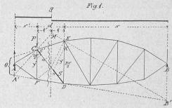
sich nach einer von Culmann angegebenen Construction in folgender Weise: Man verlängert die Seite DF des Zugbaumes bis zu den Schnittpunkten A' und B' mit den Verticalen durch die Stützpunkte A und B, verbindet A' mit C, B' mit E; die Verticale g durch den Schnittpunkt M dieser beiden Geraden ist die Belastungsscheide. Die grösste Zugspannung in der Diagonale tritt ein, wenn das Stück der Fahrbahn zwischen g und dem Widerlager B total belastet wird; die complementäre Belastung zwischen g und
