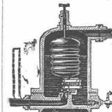
Patent-Püschel zum rationellen Entwässern von Dampfheizungsanlagen, Heizschlangen und Kochgefässen, Dampfcylindern etc. Zuverläss. Apparat.
