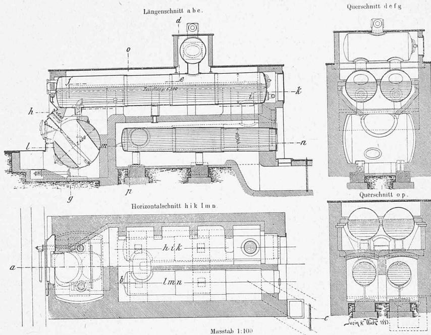
Von den beiden Unterkesseln steigt der rechte etwas nach vorn, der linke etwas nach hinten an; ersterer empfängt das Speisewasser, das dann in diesem Körper nach vorn, dort in den zweiten über- und nach hinten geht, um in die Oberkessel aufzusteigen. Linker Unter- und linker Oberkessel sind mit einem weiten Stutzen, beide Oberkessel mit einem Rohr verbunden.
