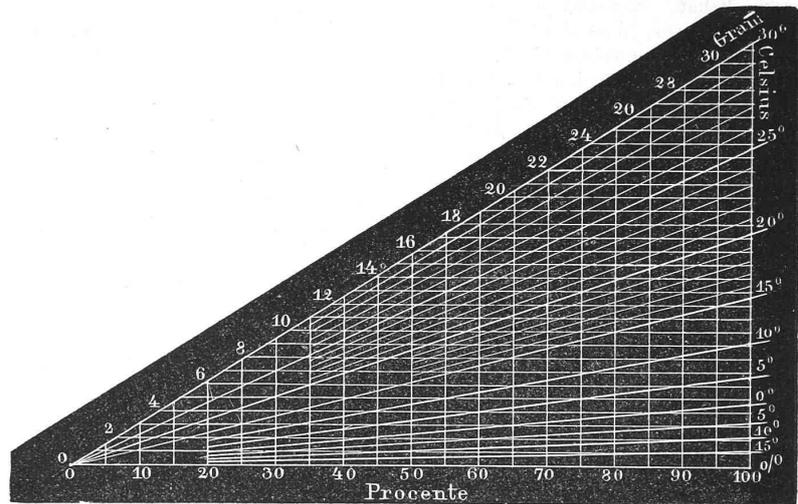
Diagramme den Schnitt dieser beiden Linien und findet in derselben Horizontalen links als absolute Feuchtigkeit 6 Gramm pro Cubikmeter und rechts den Thaupunkt bei 3°.
