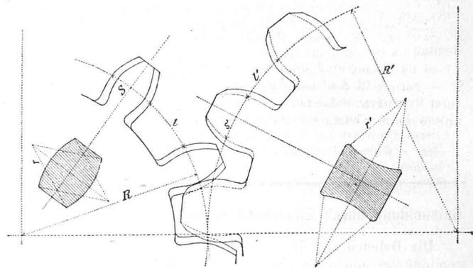
Die Zahnflanken zweier ineinander greifender Stirnräder sind bei der üblichen Einrichtung durch Cylinderflächen gebildet, deren Grundlinie eine Cycloïde oder eine Evolvente zu sein pflegt. Bei der vorliegenden Construction sind diese Flanken aus Rotationsflächen gebildet, deren Erzeugende zwar dieselbe Cycloïde oder Evolvente sein kann, die sich aber dann je um eine Achse drehen muss, um die Flankenflächen zu erzeugen.
