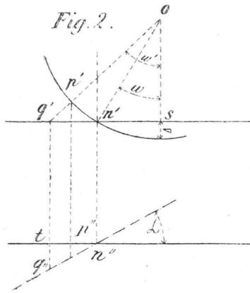
Führt man successive Schnitte durch die Radaxe, wie z. B.  $o p q$ , so erhält man an der Bandage stets denselben Querschnitt, während anderseits die Entfernungen  $p' q'$  und  $t q''$  die relative Stellung des Schienenquerschnittes angeben.
