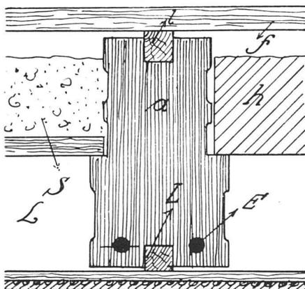
Fig. 2. Eine Decke mit Balken und Holzfussboden.
