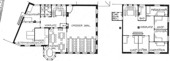
Grundrisse vom Erdgeschoss, ersten Stock und Dachstock.
