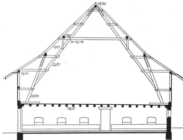
Querschnitt durch den Stallteil des Oekonomiegebäudes. — Masstab 1:150.
