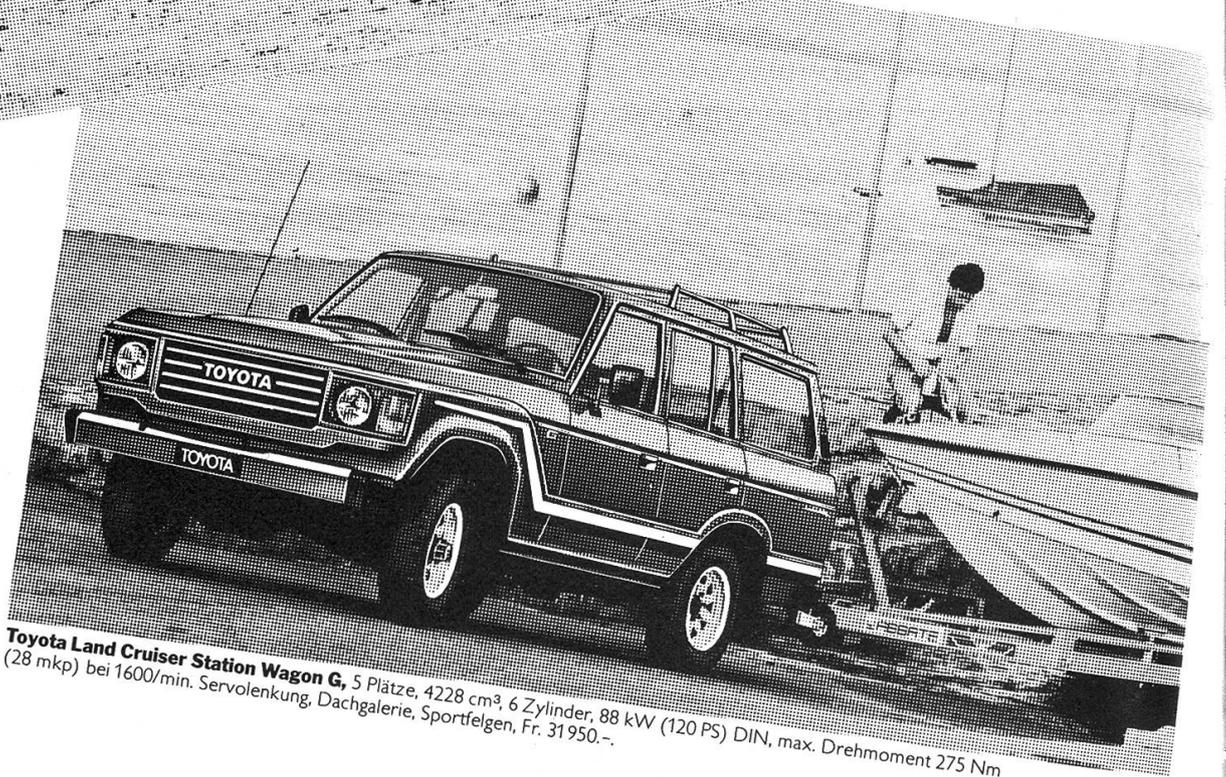
**Toyota Land Cruiser Station Wagon G**, 5 Plätze, 4228 cm<sup>3</sup>, 6 Zylinder, 88 kW (120 PS) DIN, max. Drehmoment 275 Nm (28 mkp) bei 1600/min. Servolenkung, Dachgalerie, Sportfelgen, Fr. 31 950.-.
