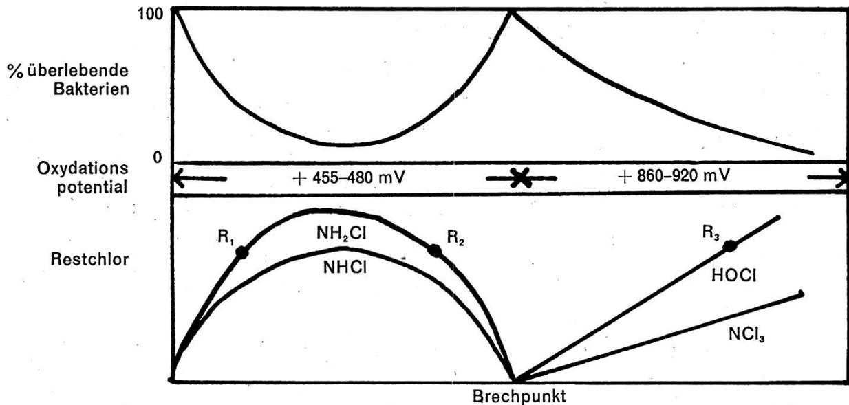
Aus Erfahrung (Butterfield und Wattie 1946) kommt es zu einer Bildung des Brechpunktes bei einem Verhältnis von  $\text{Cl}_2:\text{N} = 6$  bis  $25:1$ , theoretisch (Heicken 1956) bei  $6,4:1$ . Nach Milroy (zit. Allen 1950) führt die partielle Chlorierung verschiedener Aminosäuren zu totalem Verlust der Desinfektionswirkung.
