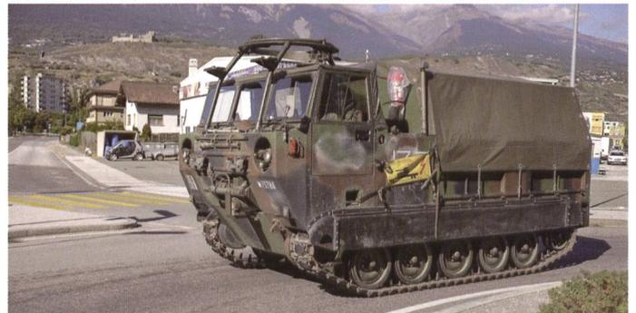
Ci-dessus: Deux vues de la chenillette de transport M-549. Cet engin est construit sur les bases du M-113 vu précédemment. Il partage également de nombreuses pièces de rechange avec le M-109. Cet engin sert au transport de munitions et dispose à cet effet d'outils de levage et de manutention. Les obus d'artillerie sont transportés dans des alvéoles dédiées.
