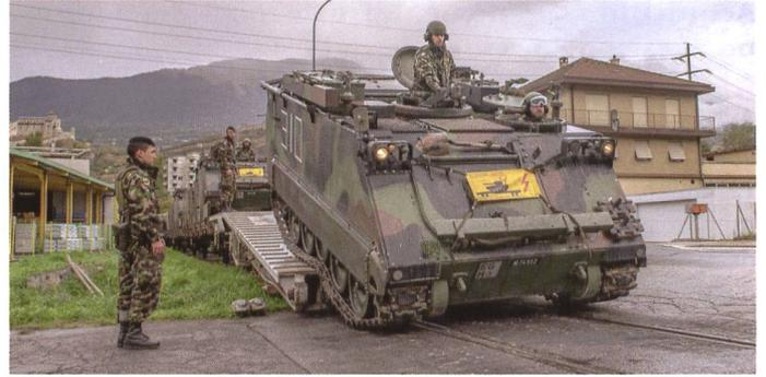
Déchargement d'un char de commandement M-113, reconnaissable à ses nombreux accessoires, radios supplémentaires et une armature à l'arrière permettant d'ériger très rapidement une tente.
