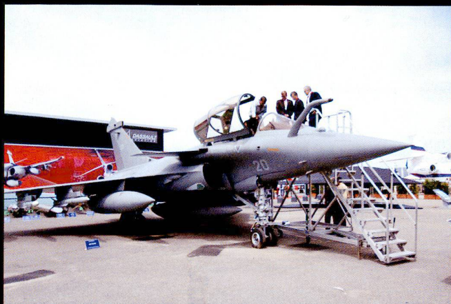
Le Rafale version armée de l'Air se distingue par un train et une crosse plus légers que son frère de l'Aéronavale. Celui-ci est présenté sur le stand Dassault.
