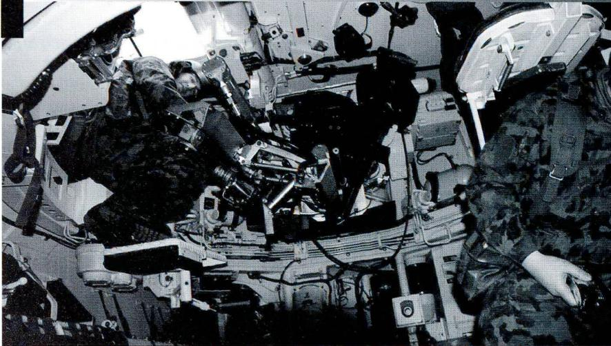
Compartment de combat de l'obusier blindé M-109. Le chargement des munitions de 15,5 cm est assisté par un système hydraulique.
