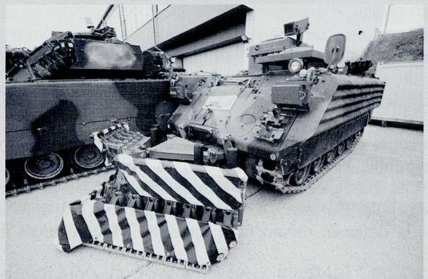
Le char de déminage léger est en mesure de dégager des routes ou des sols durs sur une largeur de 4 mètres.
