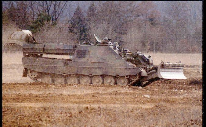
Le char du génie permet d'ouvrir des brèches en terrain meuble. Il est équipé d'une lame, d'un bras articulé et peut recevoir un système de déminage lourd.
