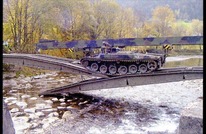
Le char poseur de pont 68/88 permet de franchir des coupures jusqu'à 18 mètres. Armeefilmdienst.
