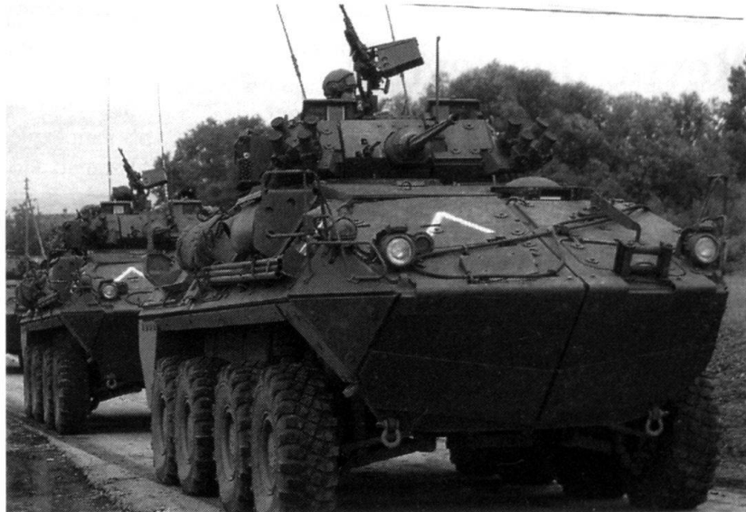
Le Coyote, un Mowag de 3 e génération avec blindage renforcé, utilisé dans les forces armées canadiennes. (Photo: Raids, août 1999).
