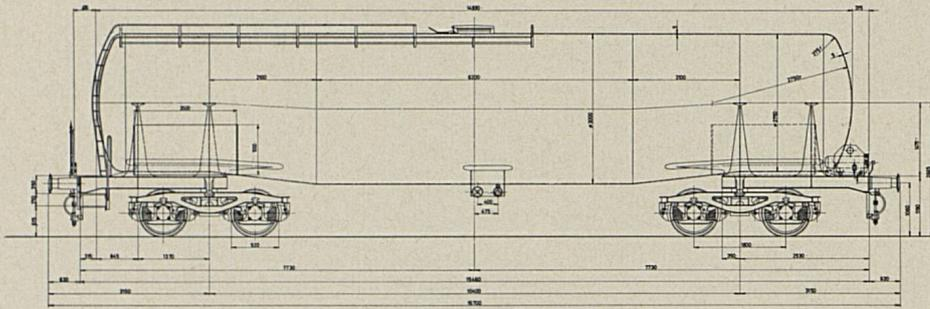
Wagon-réservoir du type Uahs pour le transport de produits pétroliers (capacité 95 m<sup>3</sup>)
