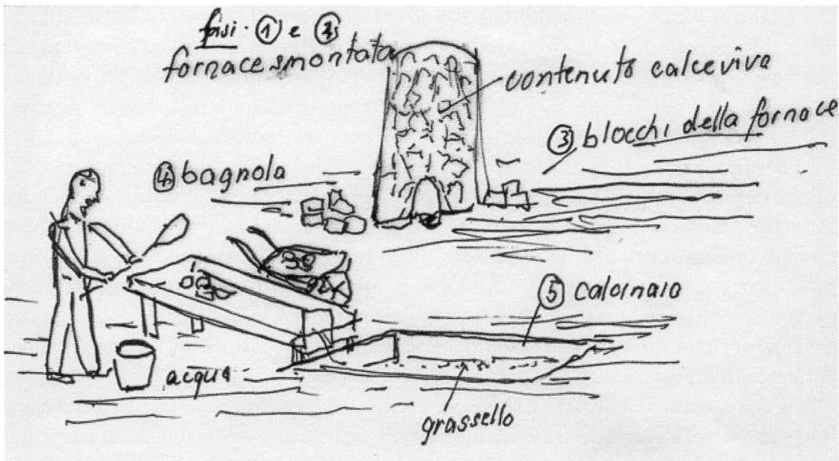
Schema delle fasi di produzione della calce
