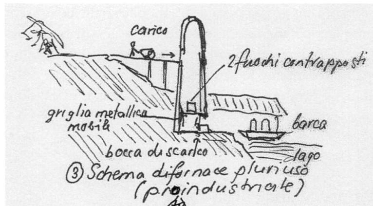
Questa tipologia consisteva in una costruzione fissa a torre, con le pareti isolate all'interno, in modo che non si distruggesse dopo la cottura. Per talune fornaci si adoperava il carbone come combustibile, disposto a strati alternati al calcare.
