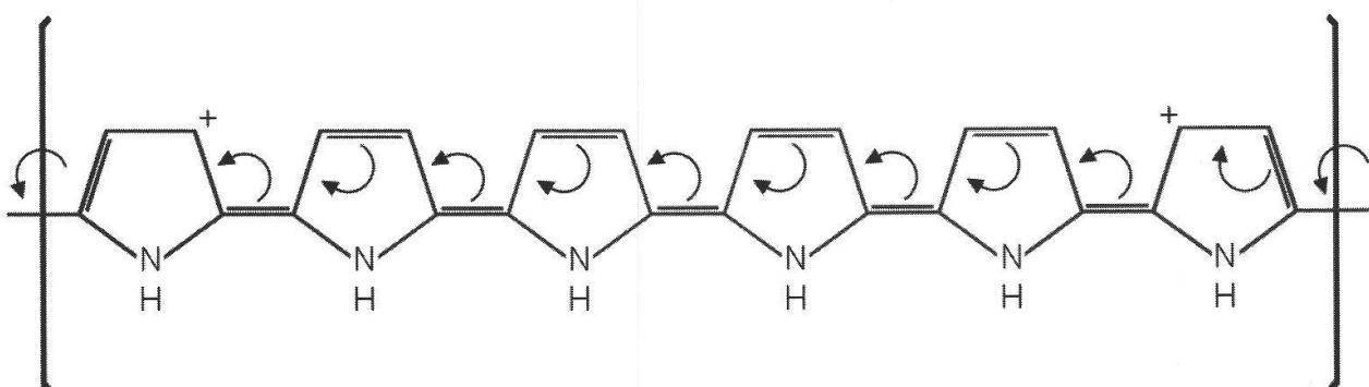
*Schema del polimero conduttore: le frecce indicano lo spostamento di elettroni sugli anelli coniugati. Il nome del polimero è Polypyrrolo dato che i singoli anelli portano il nome di Pyrrolo.*
