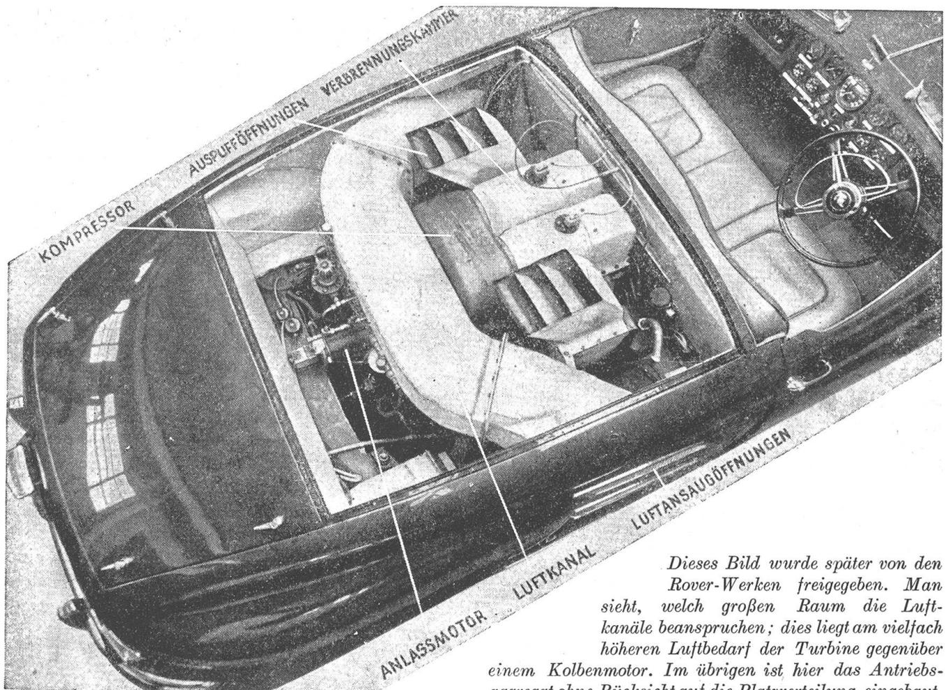
*Dieses Bild wurde später von den Rover-Werken freigegeben. Man sieht, welch großen Raum die Luftkanäle beanspruchen; dies liegt am vielfach höheren Luftbedarf der Turbine gegenüber einem Kolbenmotor. Im übrigen ist hier das Antriebsaggregat ohne Rücksicht auf die Platzverteilung eingebaut,*
