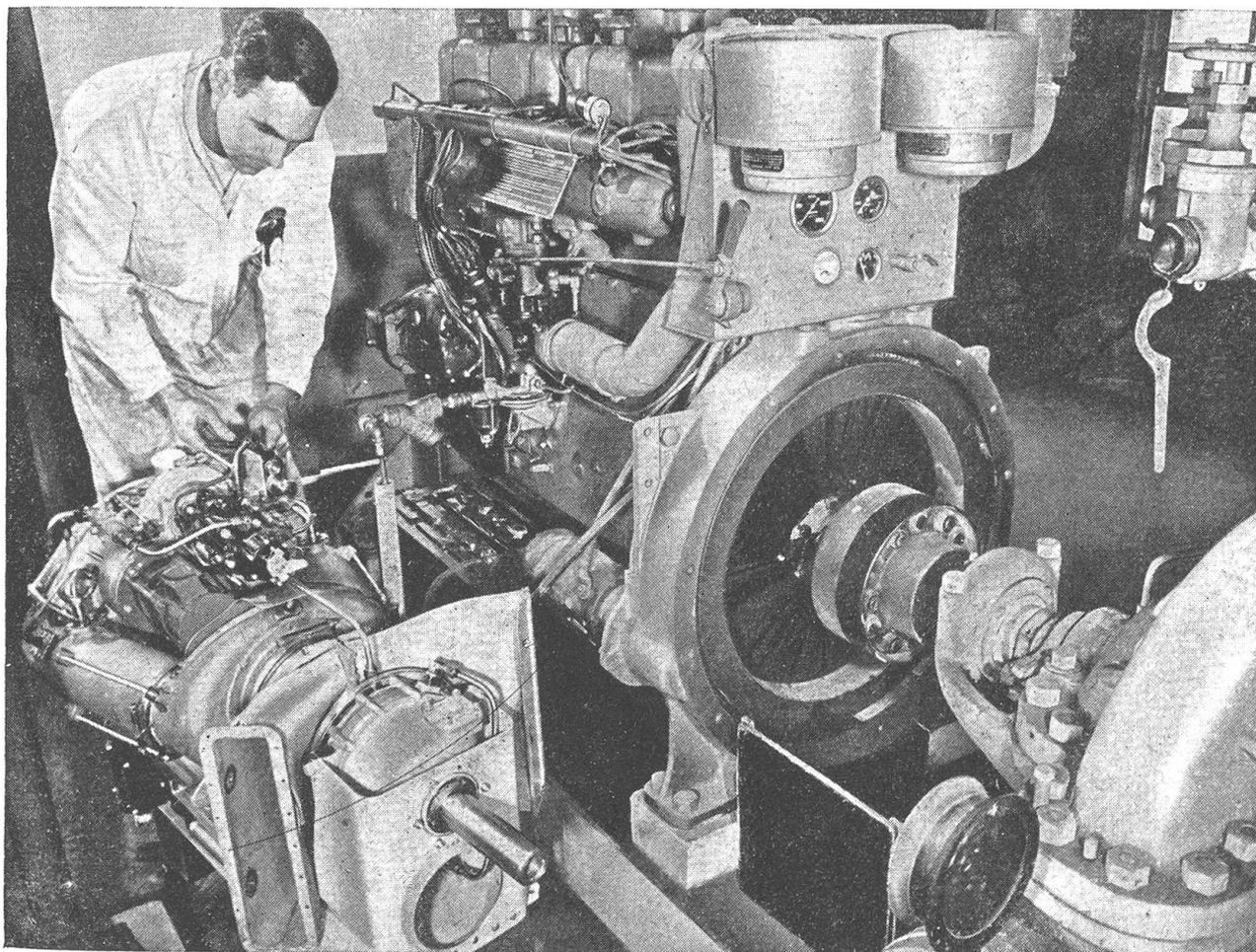
*Frappierend ist bei der Boeing-LKW-Turbine (links) ihr im Verhältnis zum gleichstarken Benzinmotor (rechts) außerordentlich geringes Volumen. Bei einer Leistungsfähigkeit von rund 180 PS wiegt sie nur 90 kg. Das ergibt ein Leistungsgewicht von 0,5 kg/PS — ein erstaunlicher Wert*
