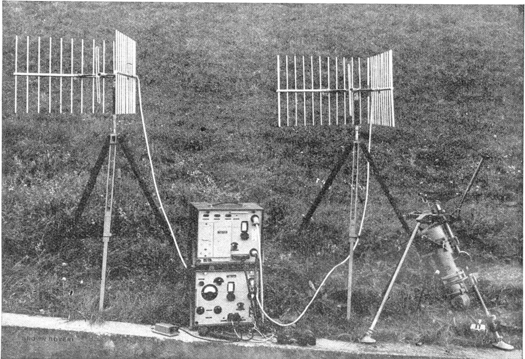
Vollständige Richtstrahlstation mit Frequenzmodulation für Betrieb im Gegenseprechverkehr über eine Distanz bis zu 200 km Links: Sendeantenne, rechts: Empfangsantenne, Mitte: Apparatekasten, rechts aussen: Treitgenerator
