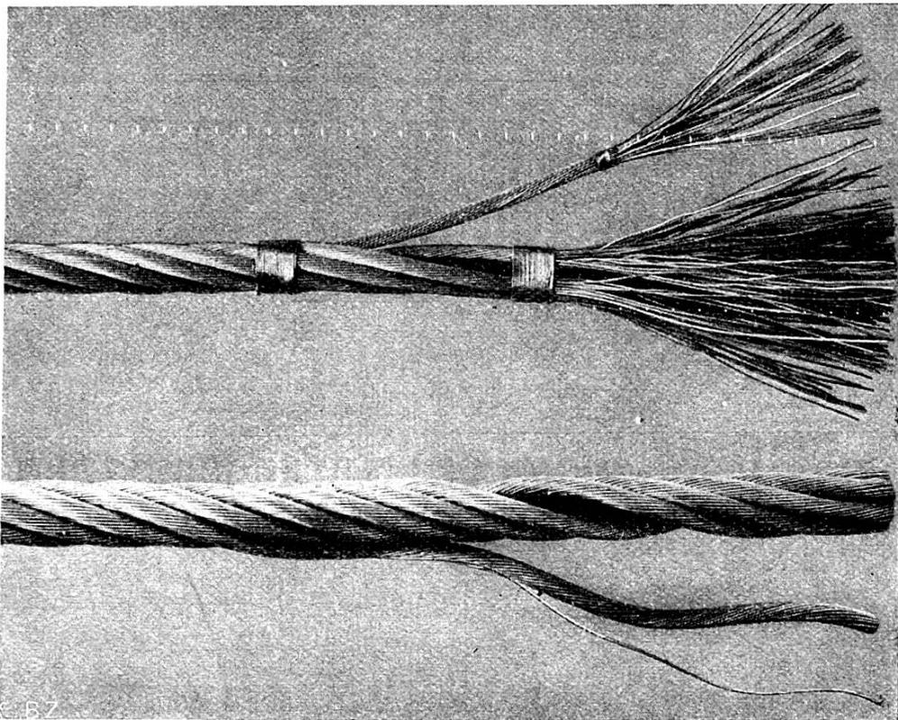
Oben: Drahtseil 15 mm  $\phi$ ,  $222 \times 0,7$  mm verzinkter Stahldraht, nicht vorgeformt.
