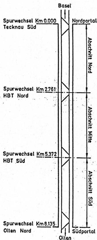
Schema der Spurwechselverbindungen im Hauenstein-Basistunnel (Zeichnung SBB)
