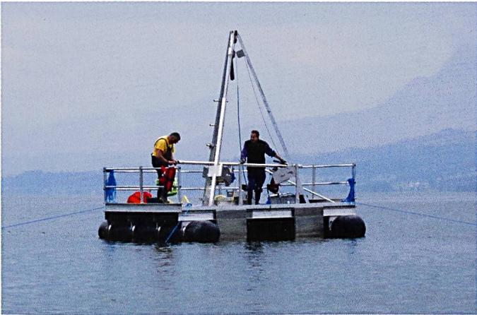
Abb. 2: Arbeitsplattform zur Abteufung von Sedimentbohrungen.
