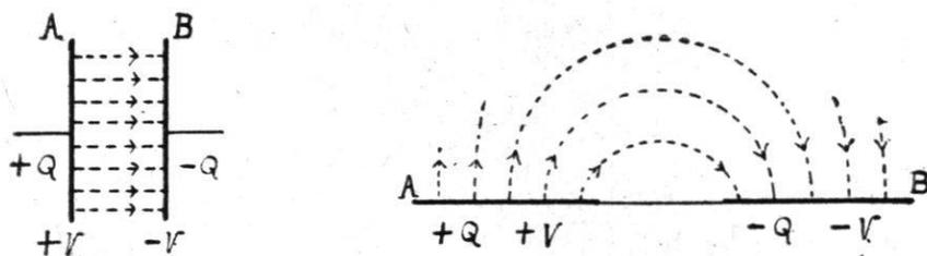
La charge et le potentiel des éléments  $A$  et  $B$  sont respectivement  $+Q$ ,  $-Q$  et  $+V$ ,  $-V$ .
