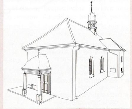
Photogrammetrische 3-D-Auswertung, Datenaustausch im DXF-Format
