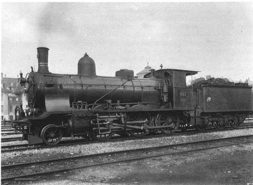
Sinne auch selbsterklärend. Alle ihre Funktionen widerspiegeln sich notwendigerweise in ihrem Äusseren: horizontaler Zylinder des Langkessels mit Kamin, Dampfdom und Führerstand, Antriebsmechanismus. Gerade die Konzentration der schweizerischen Konstruktionen in Material und Form betont dies noch<sup>3</sup>.
