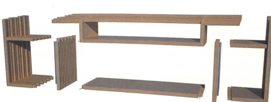
*Konstruktion eines Moduls*
