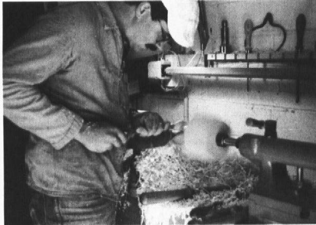
*So sauber und exakt überdrehen, dass nicht geschliffen werden muss. Die Oberfläche wird wie gehobelt. Mit Schleifmitteln würde sie nur zerkratzt.*
