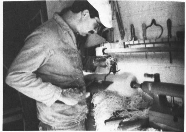
*Nochmals etwas nachstechen, bis sich der Taster über die Dicke schieben lässt. Der Durchmesser an dieser Stelle ist jetzt etwa 4 mm grösser als am Endprodukt. Es hat noch genug Holz, um einen Schlichtspan abzunehmen.*
