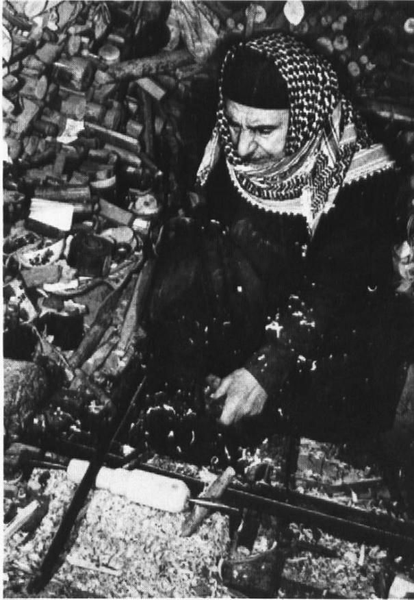
*Mit einem Schnurbogen wird das Werkstück in Rotation versetzt. Einmal dreht es gegen den Drechsler, das andere Mal von ihm weg. Im richtigen Rhythmus führt er das Werkzeug ans Holz und schneidet die Form heraus. Der rechte Fuss ist die «dritte Hand».*
