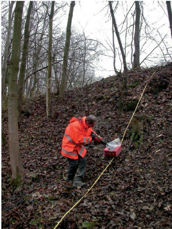
Abb. 13: Augst BL, Prospektion Insula 27 (Aktennummer 2007.106). Georadarprospektion unter erschwerten Bedingungen eines dicht mit Bäumen bestockten Steilhangs. Jürg Leckebusch führt das Messgerät entlang eines Messbandes.
