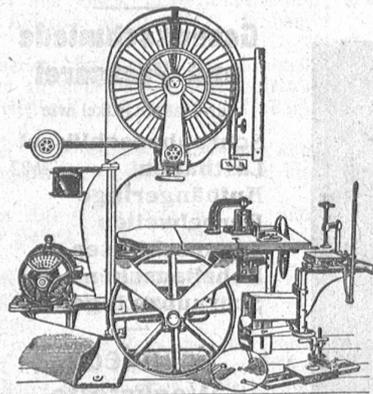
65, 70, 80 cm Rollendurchmesser mit angebautelem Elektromotor. 348
