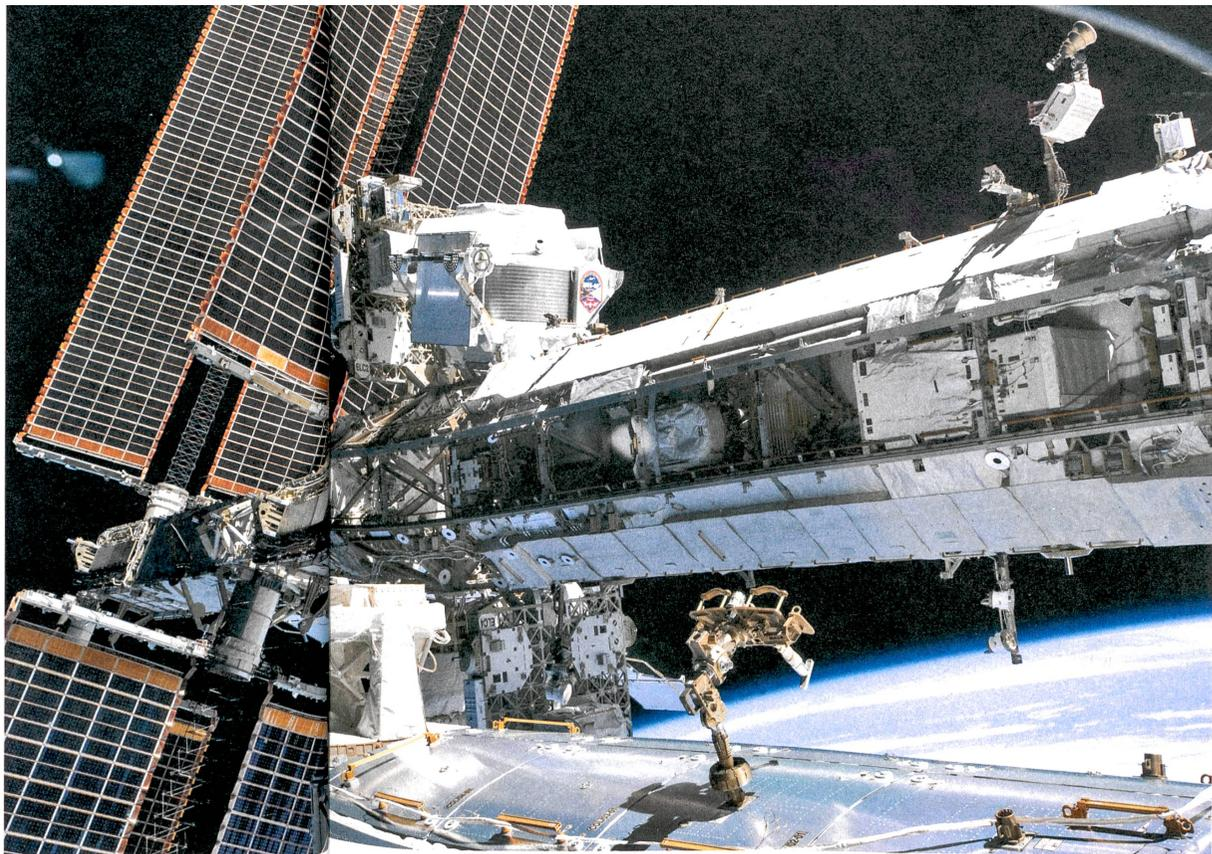
Auf der Suche nach der dunklen Materie: Die Internationale Raumstation vor dem Horizont der Erde (Mai 2013). Der weisse Kasten links oben vor dem Solarflügel ist der AMS-Detektor. Bild: Nasa
