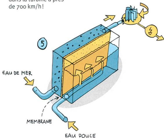
A l'heure actuelle se développe une nouvelle technique de production hydroélectrique, basée sur le phénomène de l'osmose. En filtrant par osmose au travers d'une membrane semi-perméable, de l'eau douce provenant d'une rivière exerce une pression sur de l'eau de mer et l'éjecte vers une turbine. Cette technique, encore expérimentale, est très complexe, mais présente l'avantage d'un faible impact environnemental.
