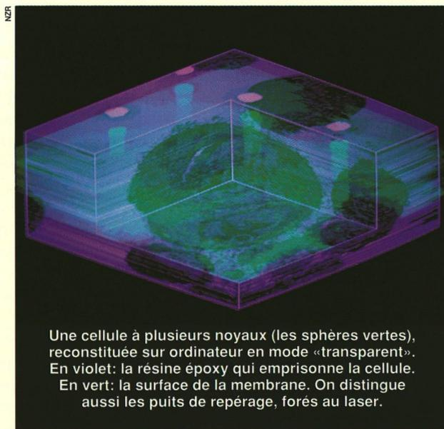
Une cellule à plusieurs noyaux (les sphères vertes), reconstituée sur ordinateur en mode «transparent». En violet: la résine époxy qui emprisonne la cellule. En vert: la surface de la membrane. On distingue aussi les puits de repérage, forés au laser.
