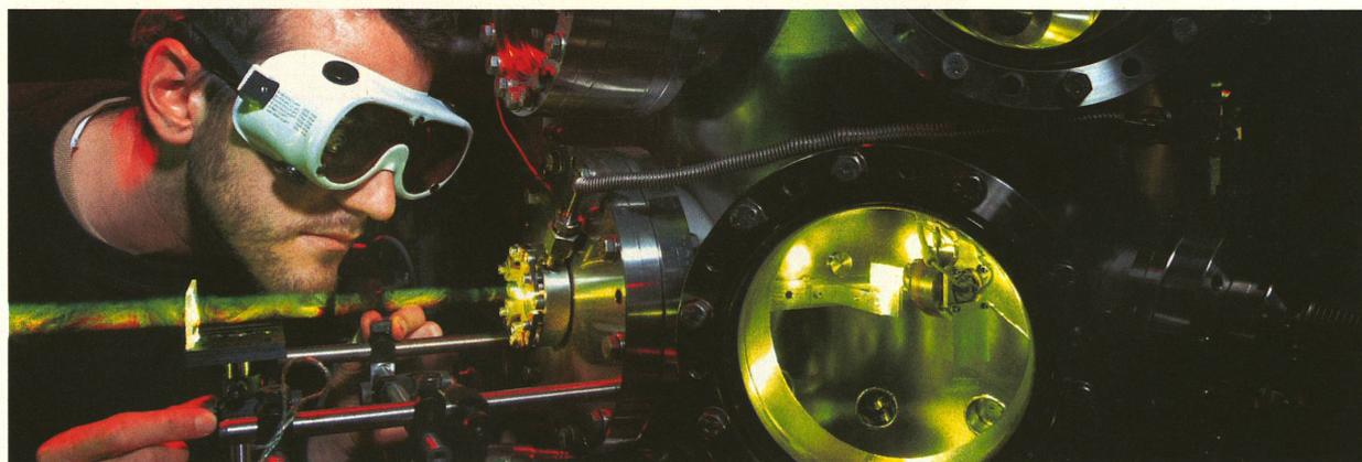
Le doctorant Plinio Maroni excite des molécules de méthane avec un rayon laser pour optimiser leur adhésion sur une surface de nickel.
