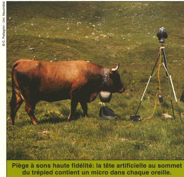
Piège à sons haute fidélité: la tête artificielle au sommet du trépied contient un micro dans chaque oreille.
