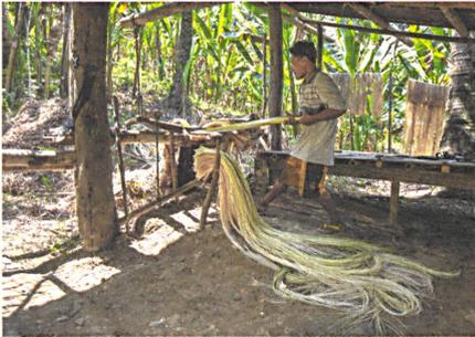
Mittels Handstripping extrahieren sie die Fasern.
