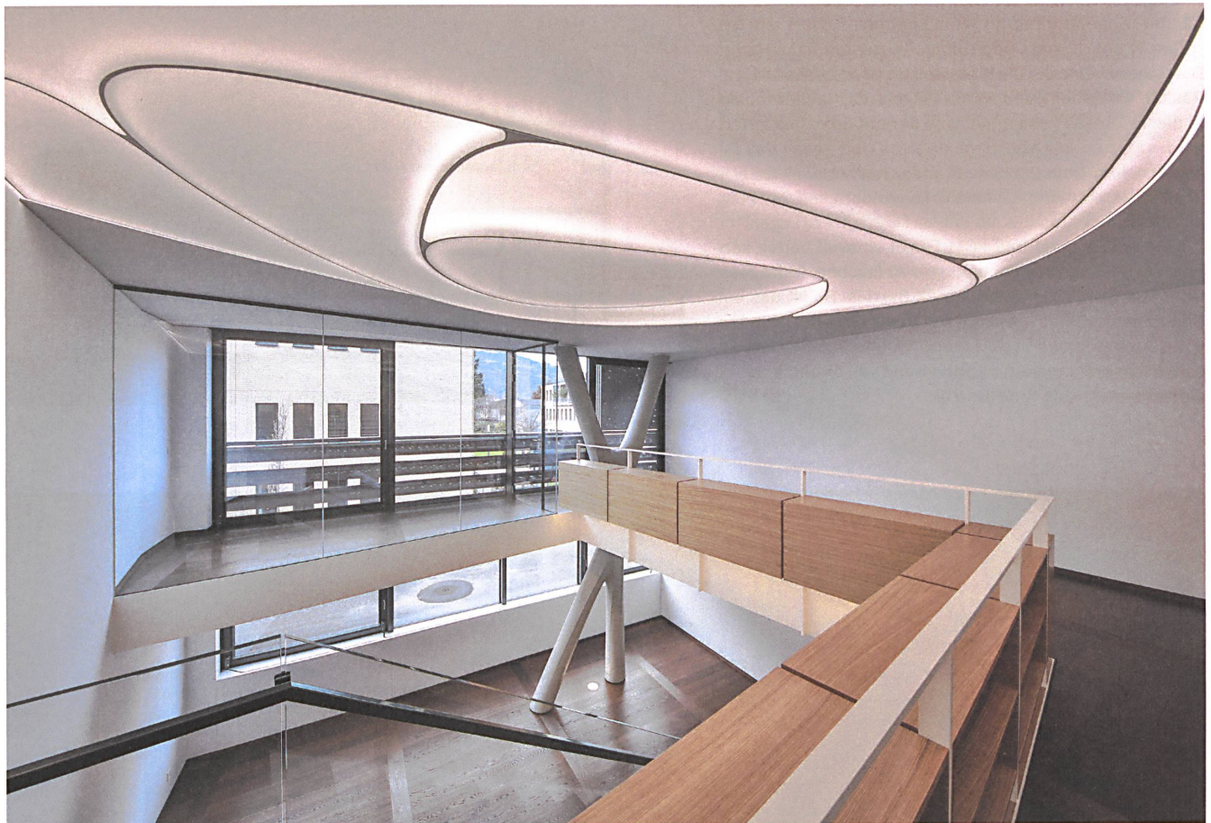
Der Leuchtkörper sitzt in einem von der Statik ausgesparten Deckenfeld und dämpft die Akustik. Der Wintergarten erinnert an die Raucherbox eines Flughafens. Fotos: Robert Korner
