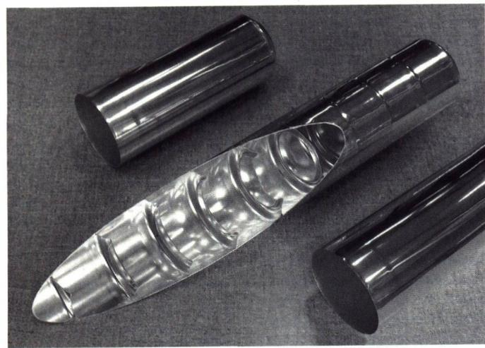
Das Bauprinzip: Ineinander geschobene und verklebte Alubüchsen; der Boden hilft stabilisieren, die minimale Überlappung zweier Büchsen beträgt 8 mm, je grösser sie wird, umso stabiler, aber auch umso schwerer wird die Stange
