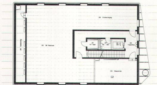
Grundriss des vierten Obergeschosses. Links der Kommandoraum, dessen Steuerpulte von unten über einen Hohlboden an den Schacht angeschlossen sind
