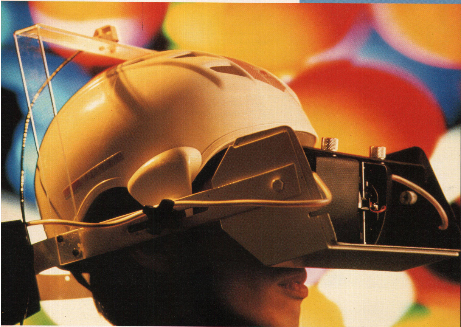
Auf einem Velohelm montierter, auf dem Kopf getragener Bildschirm der ersten Generation (vgl. Seite 27). Bild: Peter Menzel
