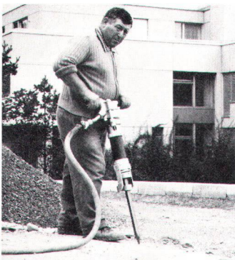
Kampf dem Maschinenlärm: Oben ein Abbauhammer ohne, unten einer mit eingebautem Schalldämpfer (Bild Stadtpolizei Zürich).
