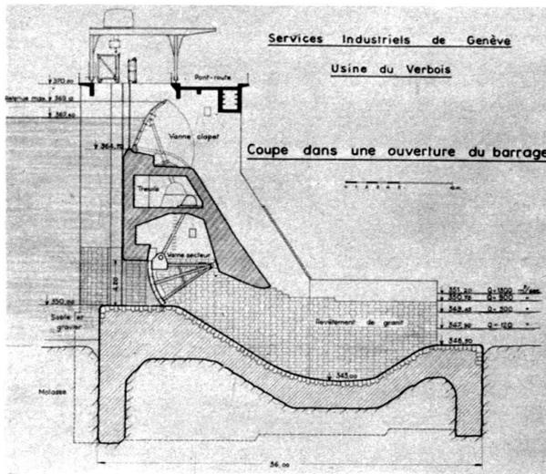
Coupe en travers d'une ouverture du barrage.
