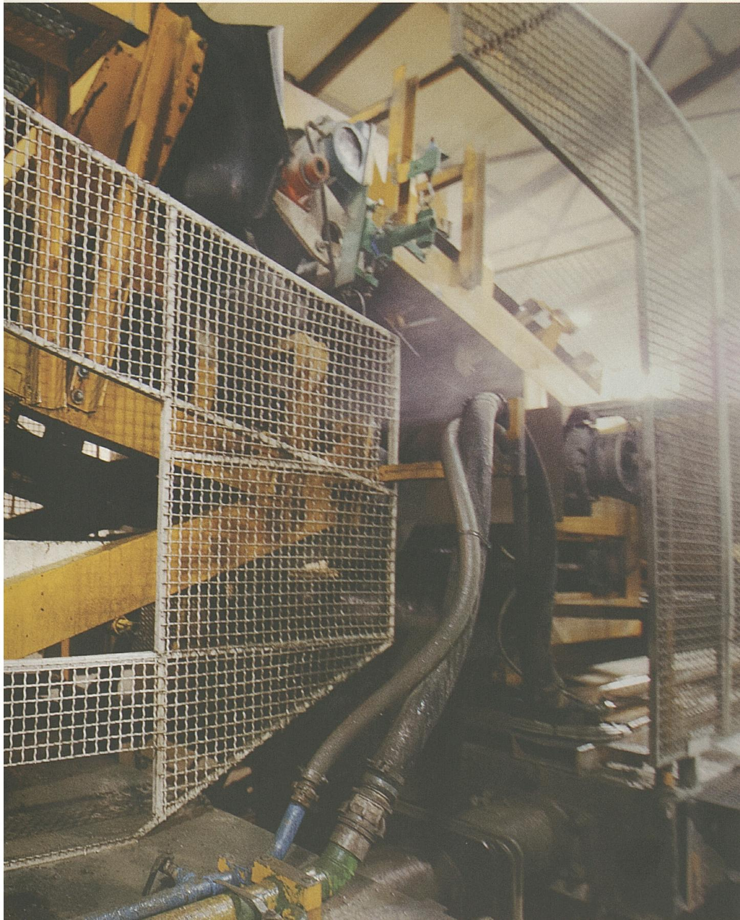
**DER BETONZUG** fährt um 20 Uhr nach zwei Arbeitsschichten aus dem Gotthard-Basistunnel auf den Bahntechnik-Installationsplatz in Erstfeld. Sechs Personen warten die Betonfabrik auf Rädern und beladen sie mit Zement, Betonzuschlagstoffen und Wasser. Pünktlich um 4 Uhr morgens steht der Zug für die nächste Schicht und den Einbau von weiteren 225 Metern Fester Fahrbahn bereit.
