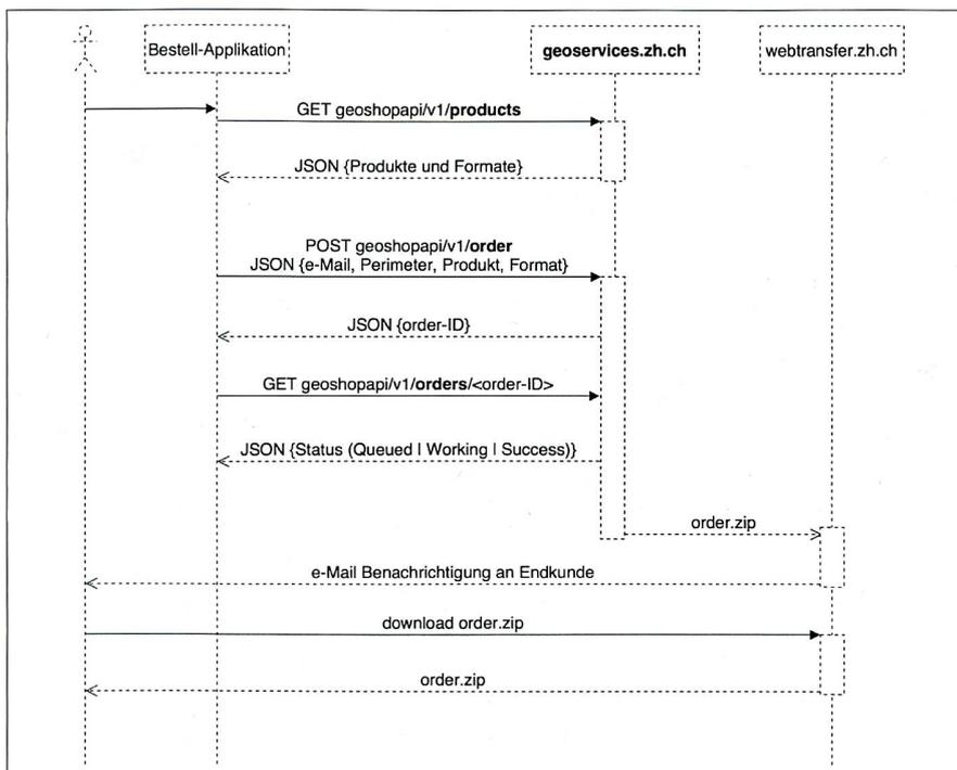
Abb. 3: Architektur und Sequenzdiagramm des Datenshop-Dienstes für die Ausführung einer Bestellung mit Anfrage des Produktes und Bestellung des Produktes und der Auslieferung.
