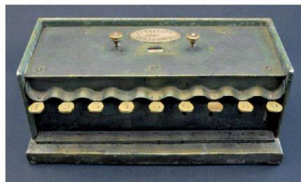
Abb. 2: Schwilgué-Tastenaddiermaschine aus Strassburg. Eine äusserst seltene Addiermaschine aus dem Jahr 1851 von Jean-Baptiste Schwilgué, dem berühmten Uhrmacher aus Strassburg (Schöpfer der letzten astronomischen Uhr des Strassburger Münsters). Die meisten führenden technisch-wissenschaftlichen Museen hatten bisher keine Kenntnis vom Schwilguéschen Gerät. Aufgetaucht in der Kulturgütersammlung der ETH Zürich am 28. Januar 2014. © Herbert Spühler, Stallikon.
