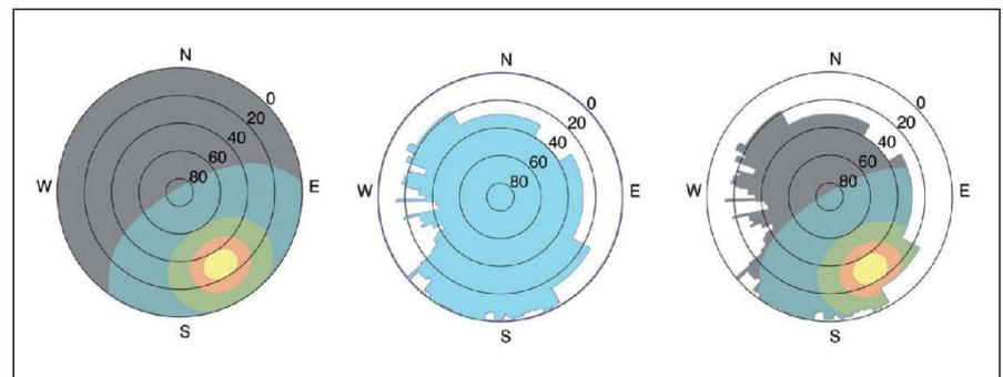
Abb. 3: Vorgehen bei der Verschattungsanalyse für die diffuse Strahlung: Strahlungsverteilung (links), Horizont (Mitte) und sichtbarer Teil der Strahlungsverteilung (rechts).
