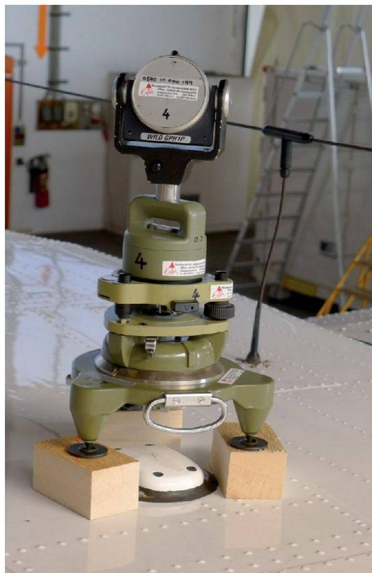
Fig. 4: Prisme au-dessus de l'antenne GNSS.
